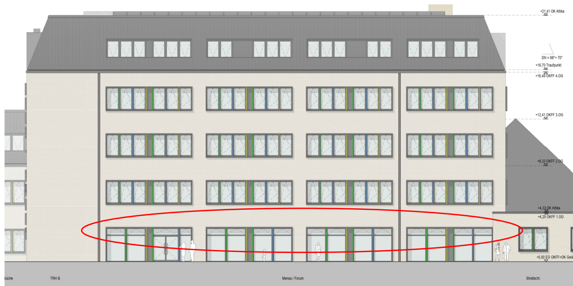
Abbildung 3: Auszug Ansichten Genehmigungsplanung mit Markierung der Öffnungen zur Rauchableitung
